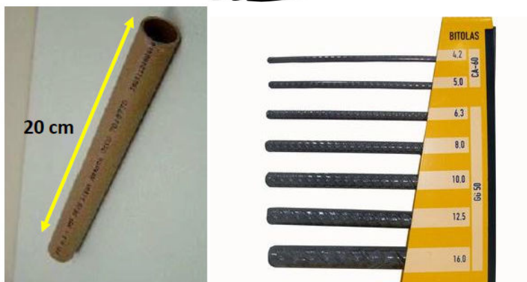
Fig. 5 – Apoios: tubo de PVC para instalação de água fria de \frac{1}{2} ” – 20 cm de comprimento - e Eixo central: barra de aço com diâmetro de 12,5 mm e comprimento função da largura do centro.
