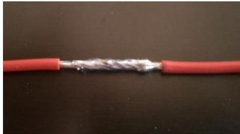
Figura B-18 – Emenda adequadamente soldada
